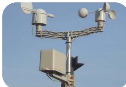
Instalación de Estación Meteorológica Automática y otros sensores de medición hidrológica.
